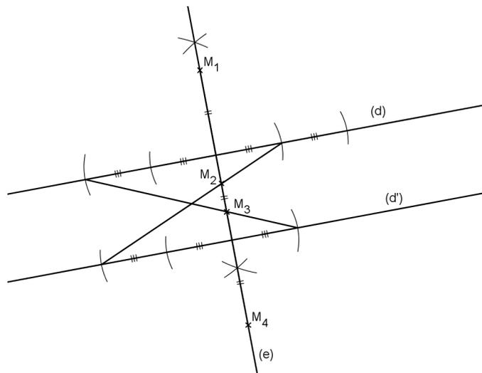
A l'aide de l'équerre, on trace la droite (d<sub>1</sub>) perpendiculaire à (e) en M<sub>1</sub>, donc parallèle à (d) passant par M<sub>1</sub>. Tracé analogue pour les droites (d<sub>2</sub>), (d'<sub>2</sub>) et (d'<sub>1</sub>).
