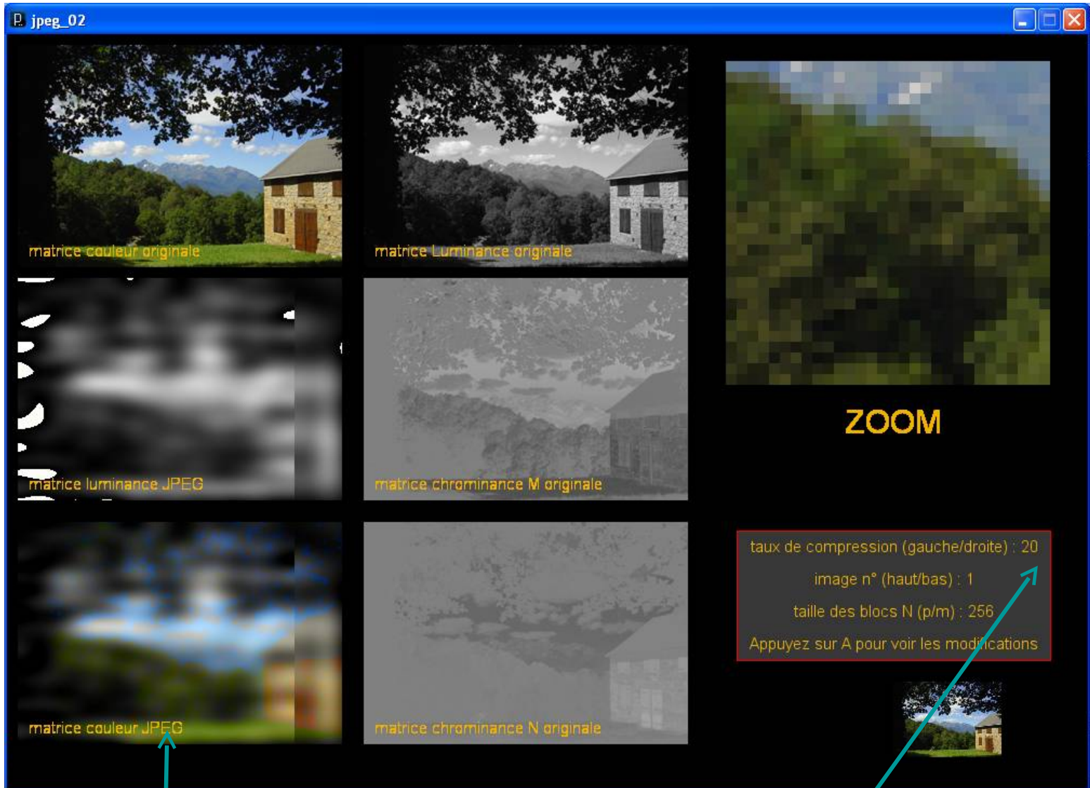
Filtrage passe-bas d'une image par compression Jpeg
